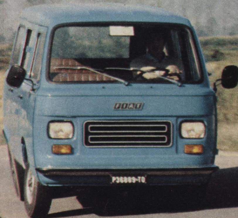
Trasportare 8 persone nel minor spazio possibile, utilizzando una meccanica economica: ecco i principali concetti cui si ispira il « 900 T », un pulmino adatto per il trasporto leggero, in grado di raggiungere, grazie al suo motore a quattro cilindri di 903 cc, i 100 km/h.
